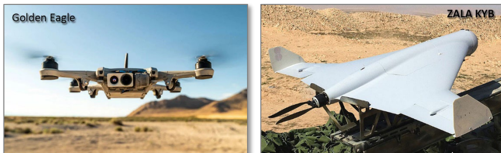
Рис. 17 – Golden Eagle – навігація без GPS/GLONASS, «КУБ» – безпілотник може баражувати у повітрі, виявляючи ціль, а потім атакувати її з верхньої півсфери вертикальним пікіруванням
