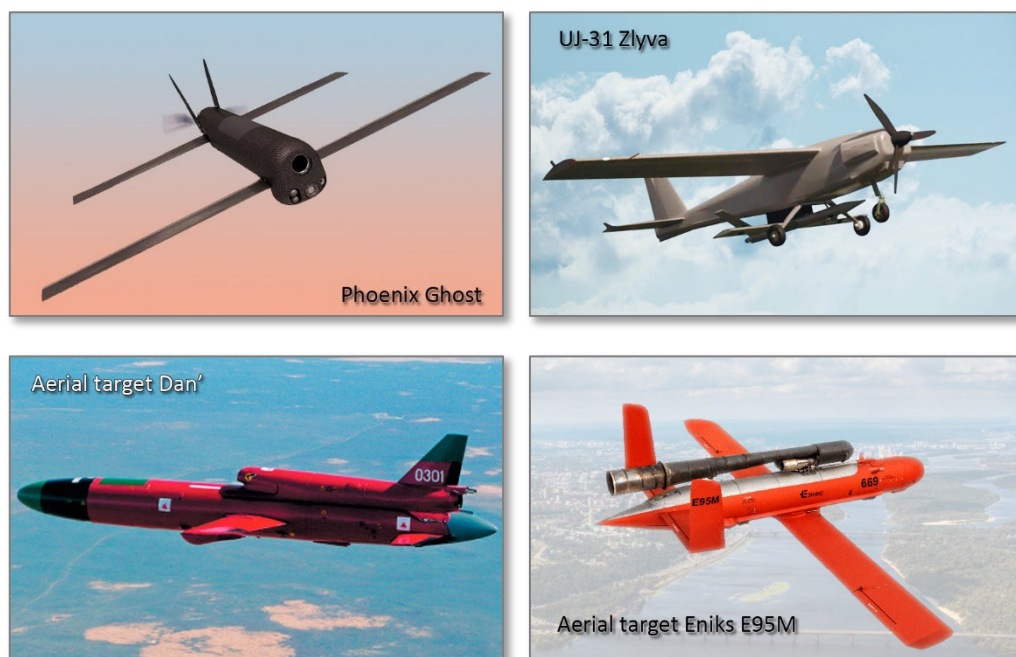
Рис. 14 – Приклади одноразових бойових БПЛА. Phoenix Ghost і «Злива» – баражуючі боєприпаси; «Дань» і «Енікс» – повітряні мішені
