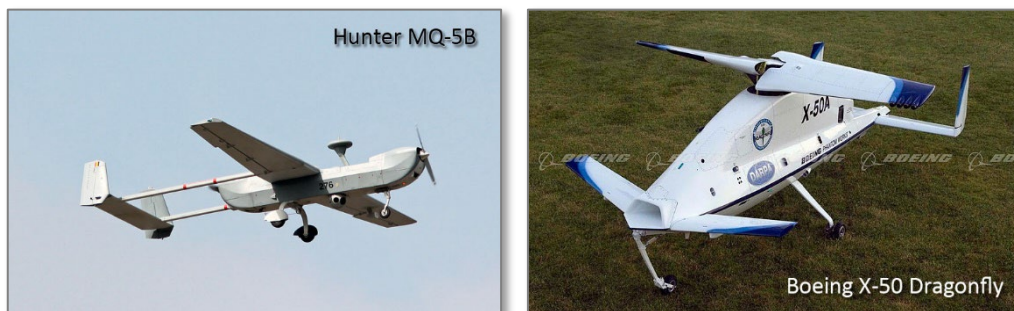
Рис. 10 – Приклади апаратів з великим навантаженням на крило – «Hunter» та «Boeing X-50»
