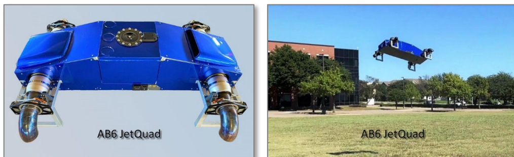
Рис. 16 – АВ6 JetQuad – турбореактивний дрон класу VTOL
