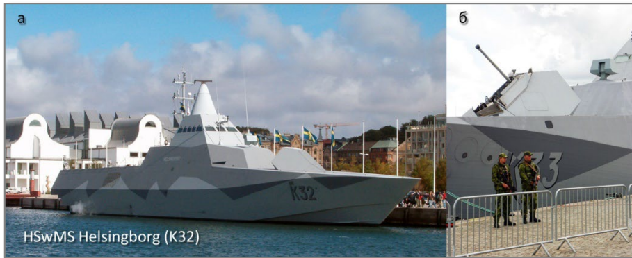
Рис. 53 – Корвет типу «Вісбю» ВМС Швеції та його гарматна вежа (б), виконані за технологією «Стелс» [31]
