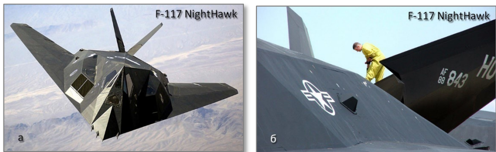
Рис. 48 – Літак F-117 Nighthawk з радіо-поглинаючими покриттями фюзеляжу:
