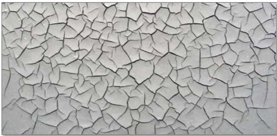
Рис. 49 – Приклад руйнування покриття у процесі експлуатації при порушеннях технологічного процесу його виробництва
