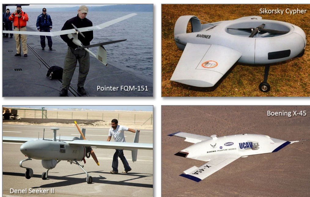
Рис. 8 – БПЛА за стелею польоту: Низькі висоти (Pointer, Cypher), Середні висоти (Denel Seeker), Великі висоти («Boeing X-45»)
