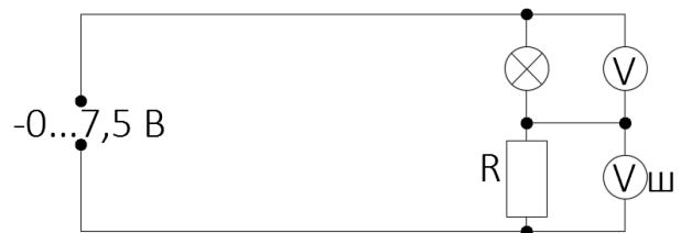
Рис. 2: Еквівалентна схема для вимірювання опору нитки із застосуванням шунта
